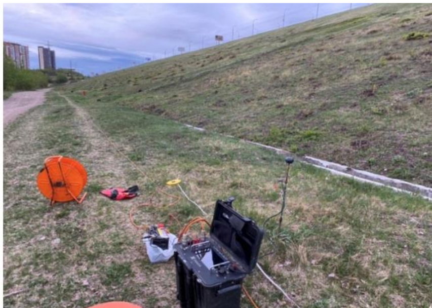
Рисунок 3. Выполнение измерений методом электротомографии
