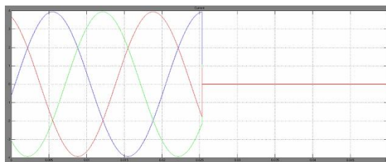
Рис. 5. Результаты моделирования графика тока при коммутации алгоритма А-В-С одновременно
