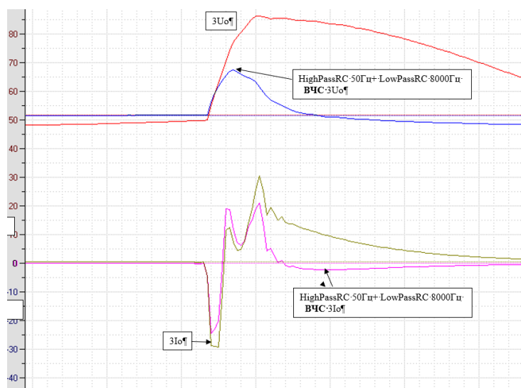
Рис. 1. Высокочастотные составляющие мгновенных значений тока и напряжения нулевой последовательности
