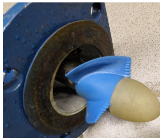
Рис. 11. РК, разработанное по подобию строения плавника кита
