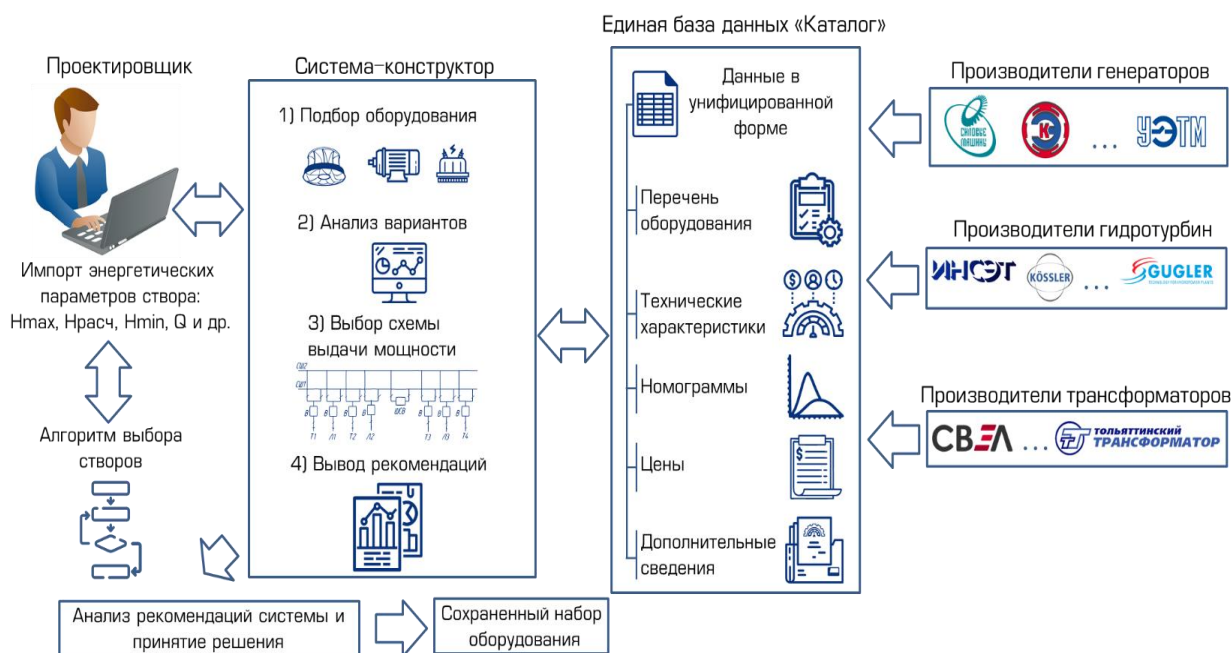
Рисунок 3. Автоматизированная система-конструктор подбора основного оборудования малых ГЭС
