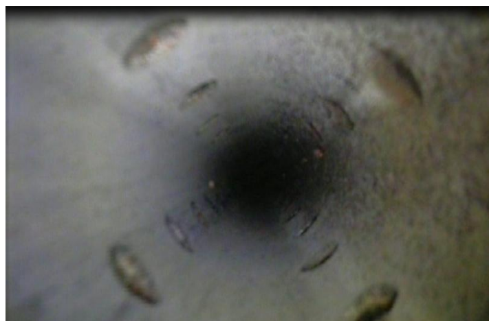
Рисунок 6. Пьезометрическая скважина П2122 а) внешний вид скважины; б) состояние фильтра
