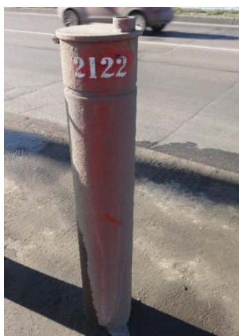
Рисунок 6. Пьезометрическая скважина П2122 а) внешний вид скважины; б) состояние фильтра
